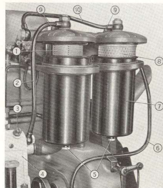
Fig. 55. - Démontage des filtres à gasoil.
