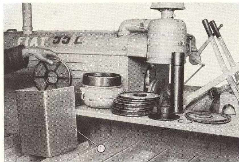
Fig. 59. - Nettoyage du filtre à air à bain d'huile.
