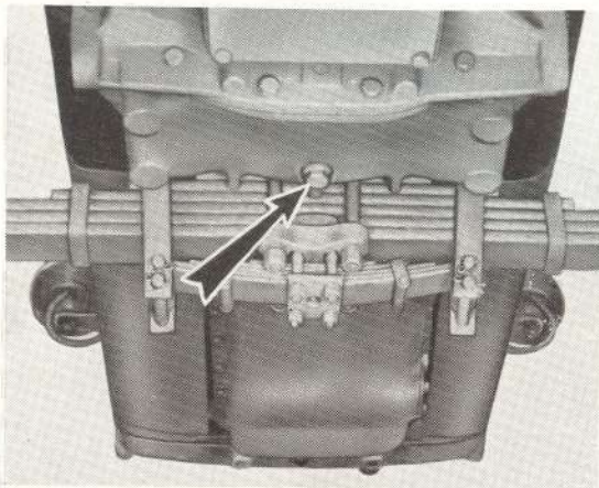
Fig. 70. - Bouchon de vidange du carter de l'embrayage central.
