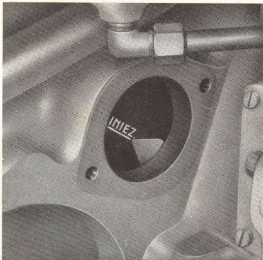
Fig. 92. - Repère sur le volant pour le réglage de la pompe d'injection.
