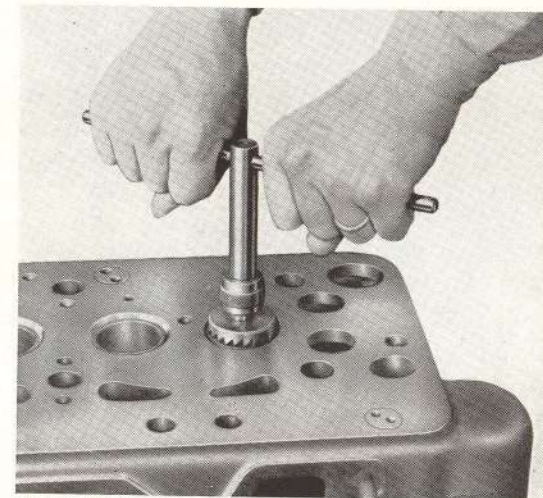
Fig. 82. - Emploi de la fraise conique pour le repassage des sièges de soupapes sur la culasse.
